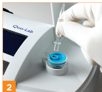
2 Nach Aufforderung den Reagenzball mit dem stumpfen Ende des Probenstäbchens in die Kartusche drücken.
