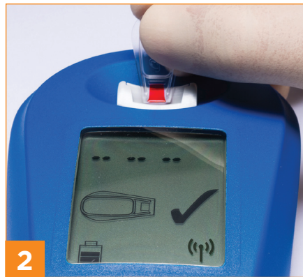
Gefüllte Küvette einsetzen und sanft nach unten drücken
